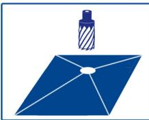
Если конструкция трапа предусматривает заливку бетоном, то необходимо вырезать в поддоне квадратное отверстие в месте установки трапа, размером чуть больше решётки трапа.
