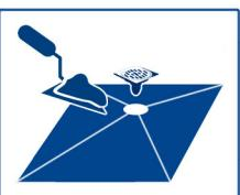
Для тех трапов, что предусматривают заливку бетоном – необходимо залить бетон в отверстие в поддоне до уровня установки решётки трапа
